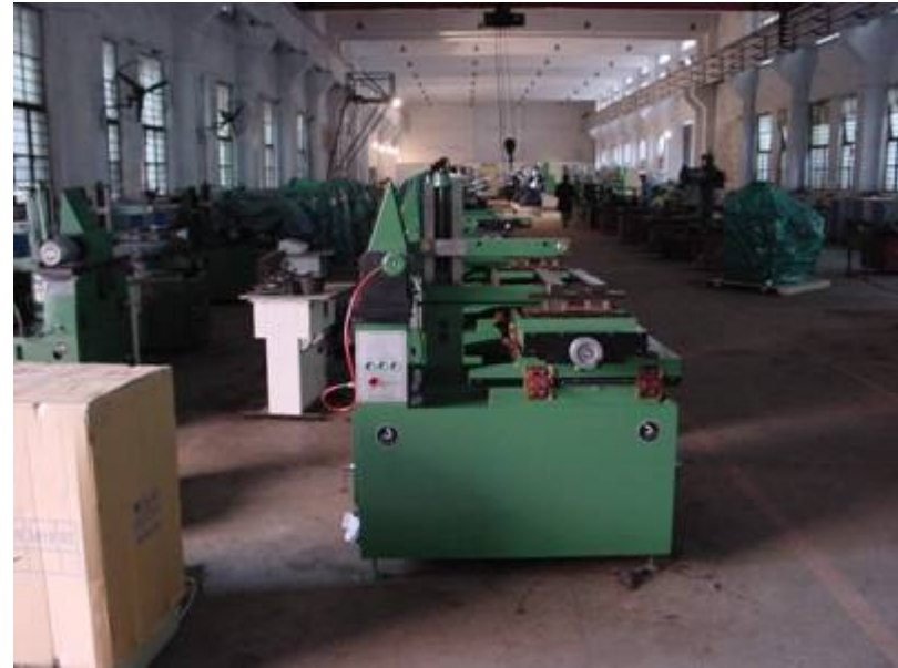
出荷を待つワイヤーカット。放電加工により金属を切る。
